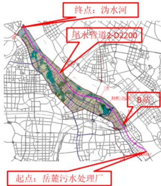
图 4-1 岳麓污水厂尾水管道平面图
