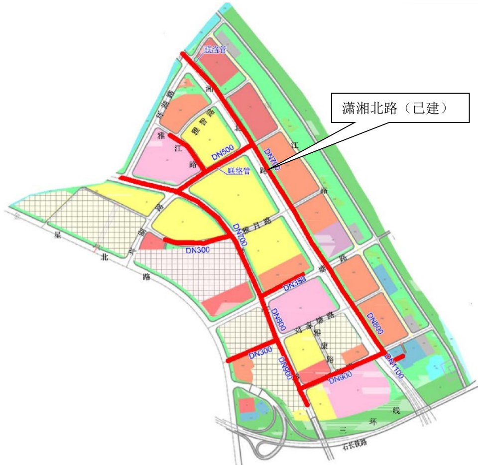
图 2-2 供能管网走线
